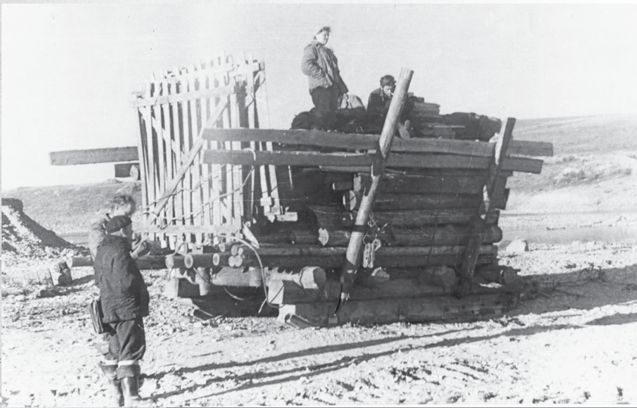
Такие сани геологи использовали для перевозки грузов. Их полозья были окованы рельсами. 1970–1980-е годы
